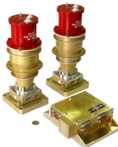
Рис. 3. Внешний вид приборов звездной ориентации (реальная фотография). Справа прибор БОКЗ-М60/1000 на ПЗС-матрице. Слева прибор МикроБОКЗ на КМОП-матрице
