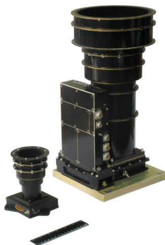
Рис. 3. Внешний вид приборов звездной ориентации (реальная фотография). Справа прибор БОКЗ-М60/1000 на ПЗС-матрице. Слева прибор МикроБОКЗ на КМОП-матрице
