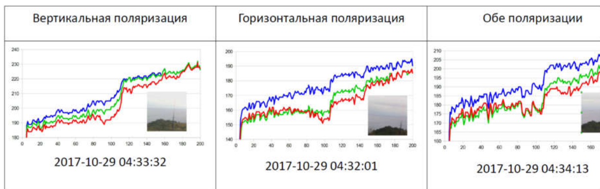
Рисунок 2.11.3 - Профили яркости утренней съемки. По вертикали графика отложена яркость, по горизонтали – угловое расстояние в пикселях от наземного ориентира. Один пиксель, соответствует примерно, одной угловой минуте. Направление на горизонт - около 110 пикселя.
