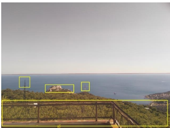
Эталонное изображение с камеры №1. На изображении выделены рамками изображения близлежащих объектов, используемых для уточнения ориентации.
