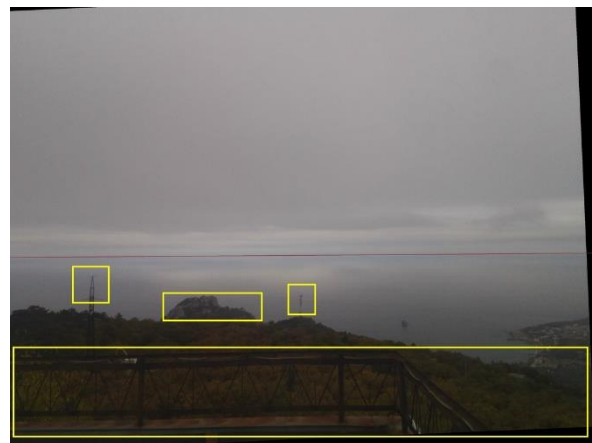
Изображение с камеры № 3, ориентация и сдвиг которого приведены в соответствие с изображением, полученным камерой №1.
