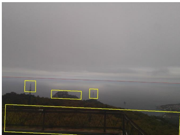
Изображение с камеры №3, на котором выделены те же самые объекты, что и на изображении с камеры №1, с учетом их сдвига и поворота.
