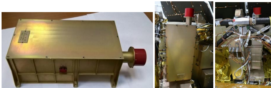
Рисунок 1. Внешний вид компактного прибора М-ДЛС и его размещения на борту стационарной посадочной платформы проекта “ЭкзоМарс-2022”
