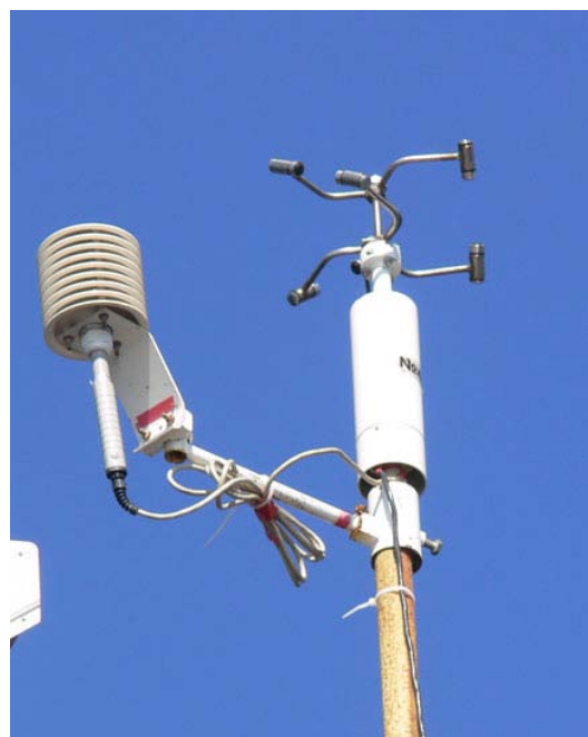
Рис. 4. Метеорологический комплекс для измерения трех компонент скорости ветра с помощью акустических анемометров
