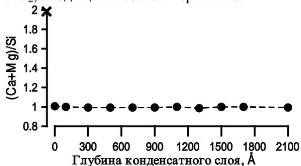
Рис. 2 Соотношение элементов в конденсате при испарении мервинита  $\text{Ca}_3\text{Mg}[\text{SiO}_4]_2$ . В конденсате отношение  $\text{Ca}/\text{Mg} \approx 1.5$ . Исходное отношение  $(\text{Ca}+\text{Mg})/\text{Si}=2$  показано крестиком.
