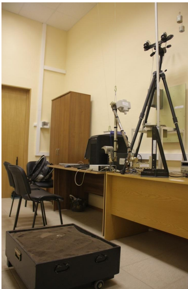
Рис.2 Имитатор лунной поверхности, камер СТС-Л и манипулятора
