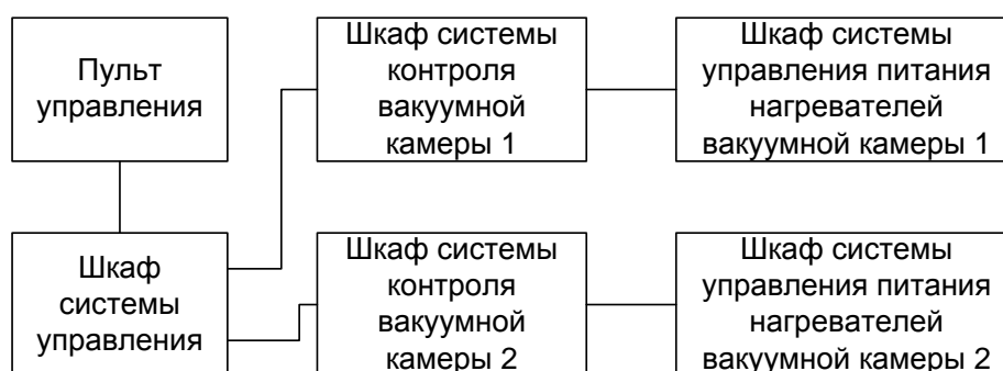
Рис. 2. Схема системы автоматизированного управления
