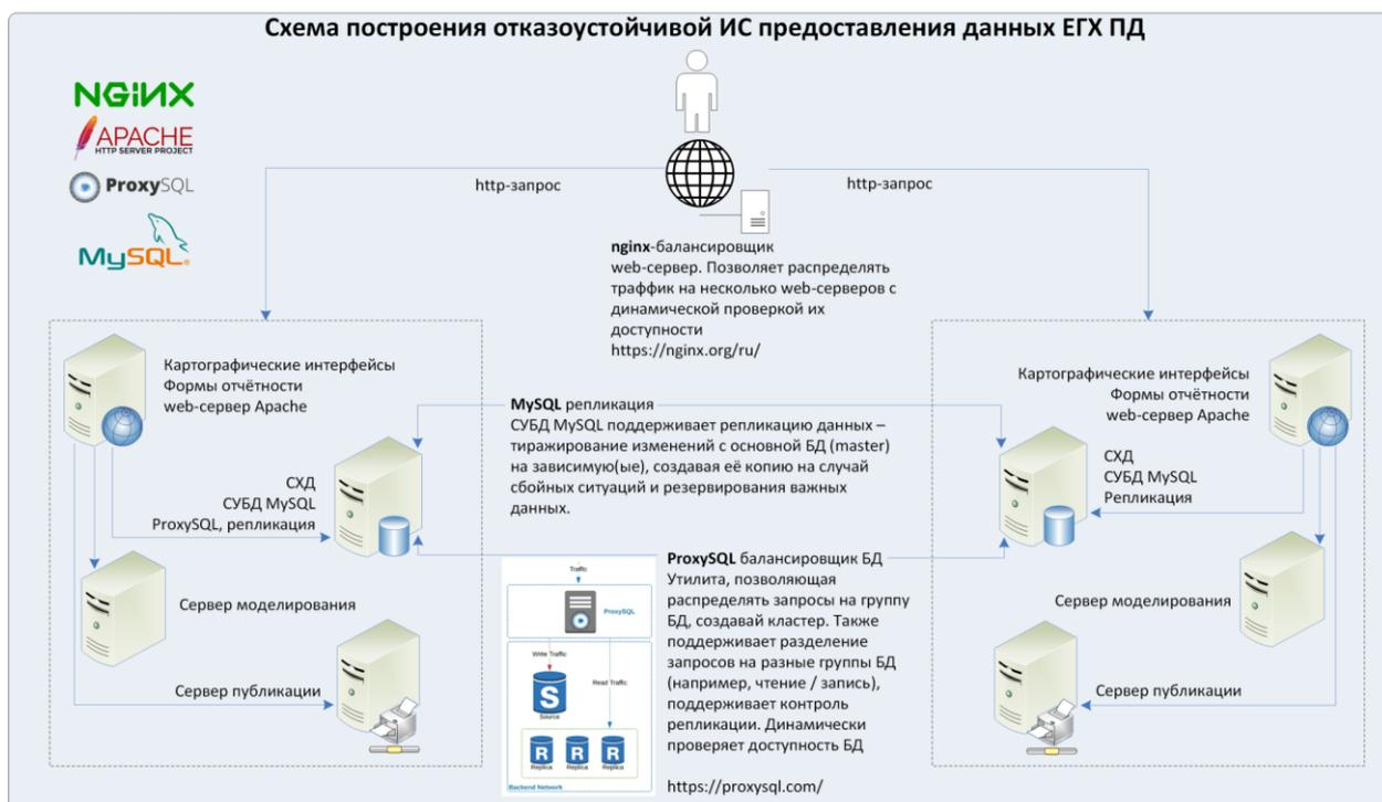
Рисунок 3.2.3.2 — Схема построения отказоустойчивой ИС предоставления данных.
