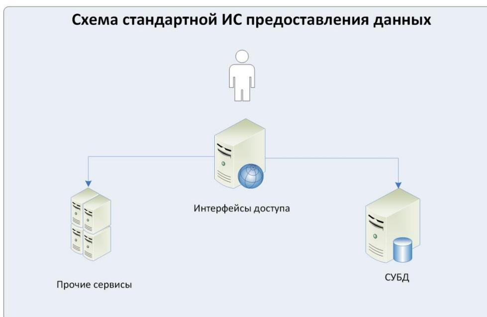
Рисунок 3.2.3.1 — Схема традиционной информационной системы предоставления данных.
