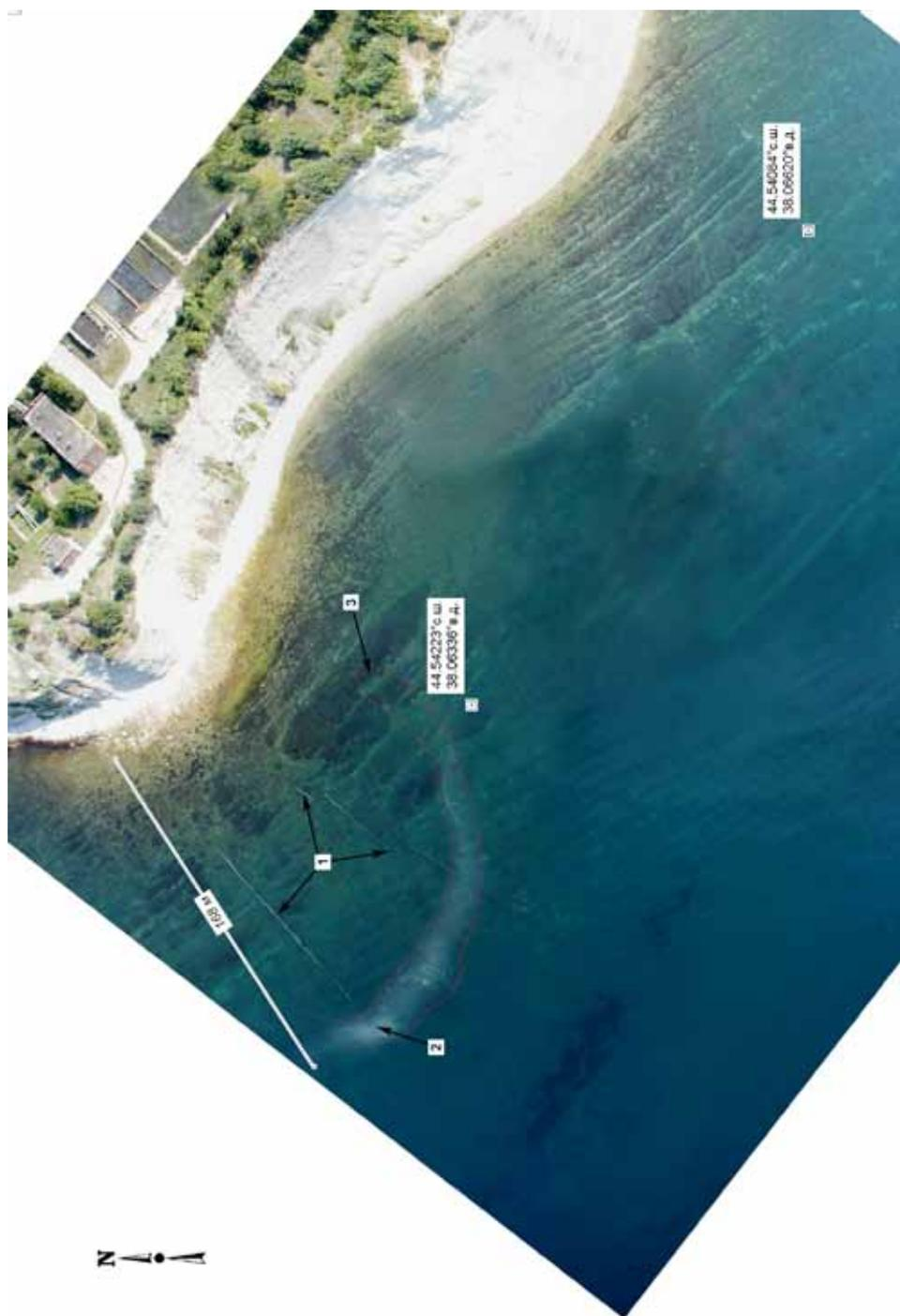
Р и с . 5.34а. Утечка сточных вод из трубопроводов глубоководного выпуска в районе Геленджика: 1 — трассы глубоководных выпусков; 2 — место утечки; 3 — зона загрязнения (3360 м<sup>2</sup>) © СЦГМС ЧАМ
