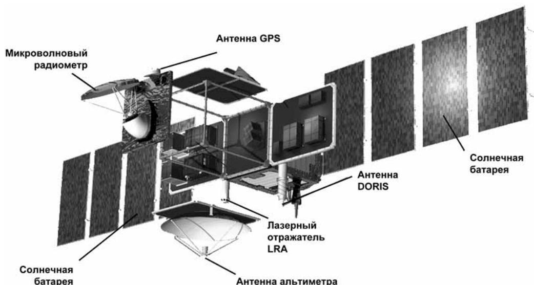
Р и с . 2.50. Комплекс приборов дистанционного зондирования Земли спутников Jason 1/2
