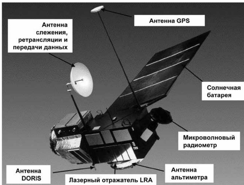
Р и с . 2.49. Комплекс приборов дистанционного зондирования Земли ИСЗ TOPEX/Poseidon
