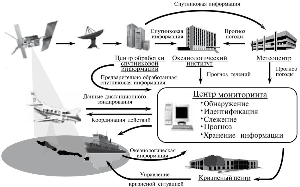
Рис. 1.1. Общая схема спутникового мониторинга кризисных ситуаций
