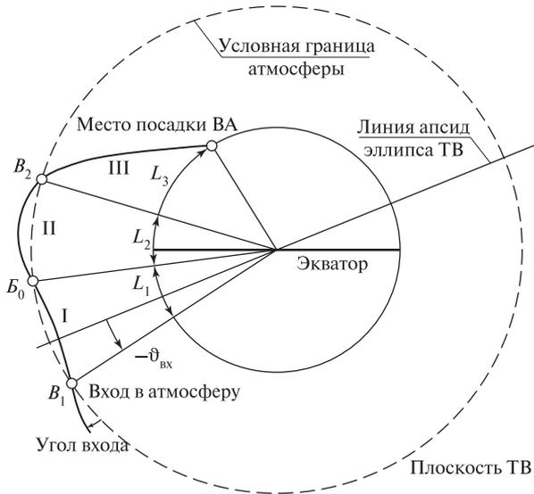
**Рис. 2.** Схема рикошетирующей траектории атмосферного торможения ВА. Важный пример:  $V_{\text{вх}} = 11$  км/с,  $\vartheta_{\text{вх}} = -5,29^\circ$ ,  $L_1 = 1900$  км,  $L_2 = 5740$  км,  $L_3 = 1960$  км,  $L_\Sigma = 9600$  км
