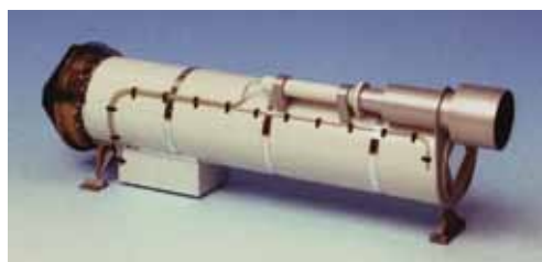
ТТМ (телескоп с теневой маской) — один из основных инструментов обсерватории «Рентген» на модуле «Квант-1». С его помощью были получены наилучшие на конец 1980-х — начало 1990-х годов карты области центра Галактики в рентгеновских лучах выше 4 кэВ
