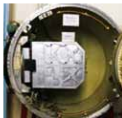
Внешний вид исследовательского блока и внутреннее расположение аппарата МКФ-6 на корабле «Союз-22» на месте обычного стыковочного узла
