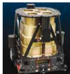
Лунный детектор ЛЕНД LEND Lunar Exploration Neutron Detector
