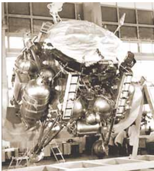
«Луноход-1» на посадочной платформе (слева) и в термовакуумной изоляции (вверху) в НПО им. С. А. Лавочкина. Ниже — первые кадры с лунной поверхности и общий вид аппарата «Луноход-1»
