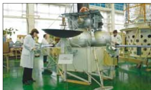
Технологический макет аппарата «Фобос-Грунт» в ИКИ на примере комплекса научного оборудования
