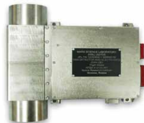
Детектор ДАН, кроме активного обследования подповерхностного слоя Красной планеты, способен вести мониторинг естественного радиационного фона поверхности
