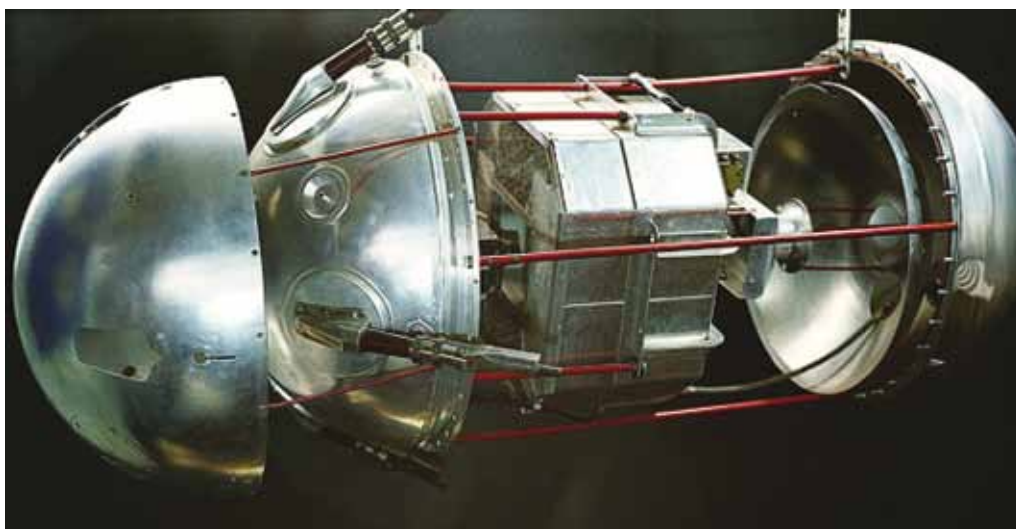
Компоновка Первого искусственного спутника Земли ПС-1
