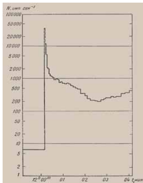
Скорость счёта экранированного счётчика Гейгера (импульсы в секунду) вспыхивы излучения от атмосферного взрыва американской термоядерной бомбы 9 июля 1962 года в 12:00:09, зарегистрированной спутником «Космос-5»
