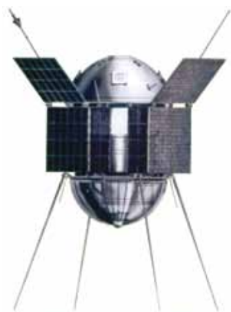
Платформа «Прогноз» НПО им. С. А. Лавочкина, на которой построено 12 спутников. Главный конструктор Г. Н. Бабакин
