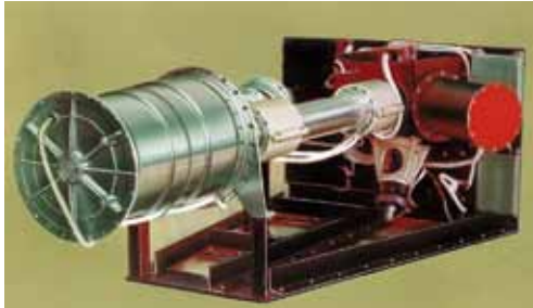
Пылеударный масс-анализатор ПУМА PUMA dust mass spectrometer
