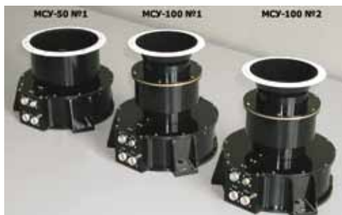
Аппаратура комплекса КМСС — одна камера MSU-50 и две камеры MSU-100
