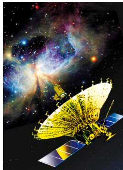
Орбитальная обсерватория «Спектр-Р» проекта РАДИОАСТРОН с 10-метровым зеркалом, построенная НПО им. С.А. Лавочкина
