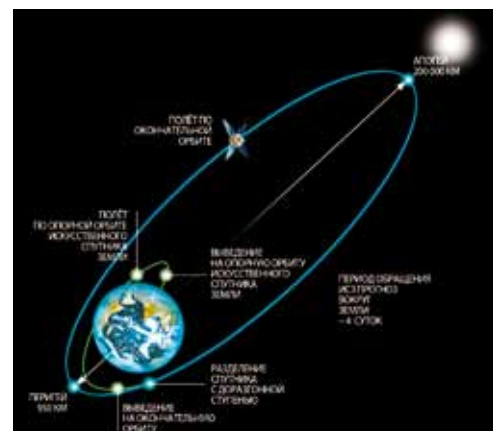
Построение типичной орбиты спутников «Прогноз»
