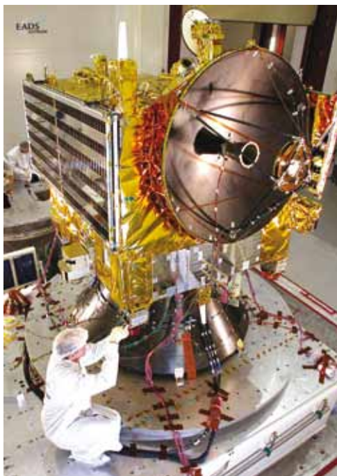
Подготовка аппарата «Венера-Экспресс» к вибрационным испытаниям
