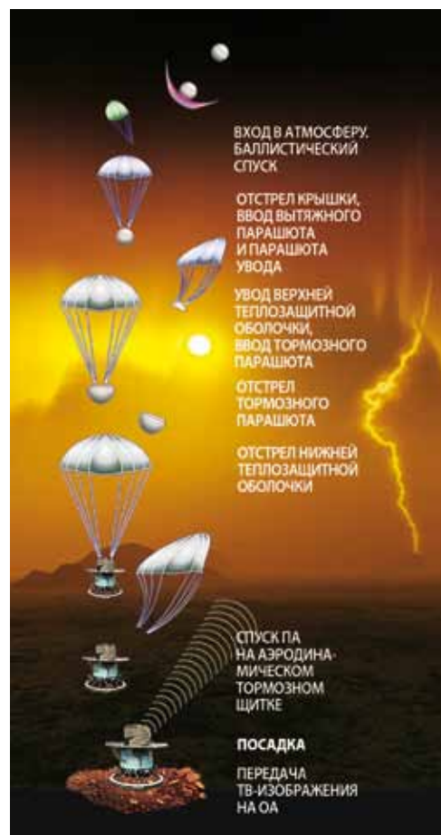
Схема посадки спускаемых аппаратов АМС «Венера-9, -10, -11, -12, -13, -14» на поверхность Венеры
