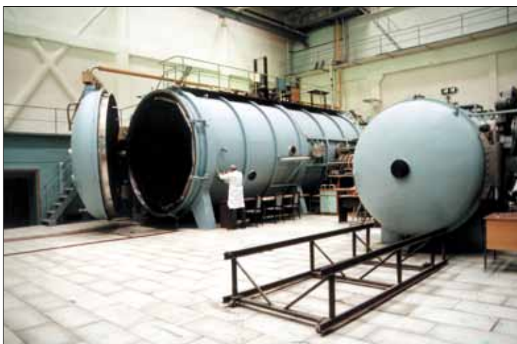
КИС (Контрольно-испытательная станция ИКИ РАН). Термовакuumная установка ТБУ-100Г/3,8-07
