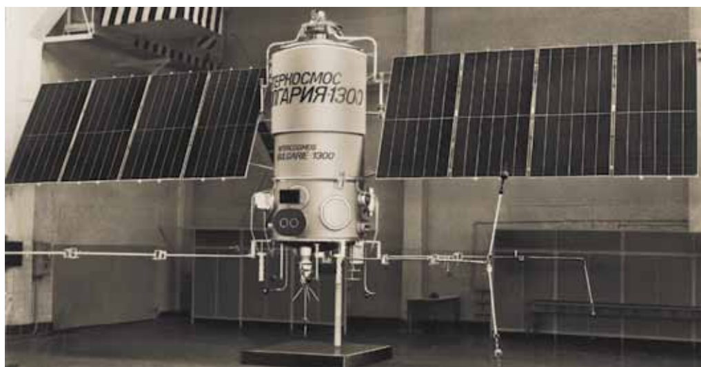
«Интеркосмос-22 – Болгария-1300» на платформе «Метеор» и установленный на нём угловой отражатель для лазерной локации
