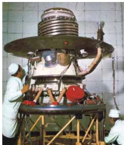
Посадочный аппарат станции «Венера-9» в монтажно-испытательном цехе НПО им. С. А. Лавочкина
