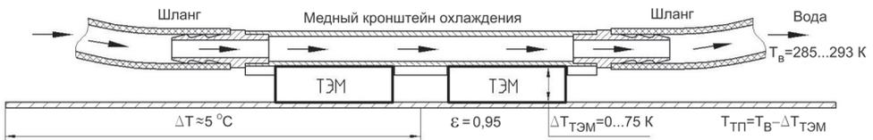
Рис. 6. Схема охлаждения одной тепловой панели экрана
