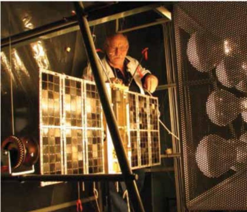
**Рис. 14.** Проверка солнечных батарей «Чибис-М»
