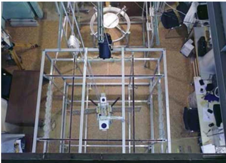
Рис. 15. Испытания системы ориентации в катушках Гельмгольца, вид сверху
