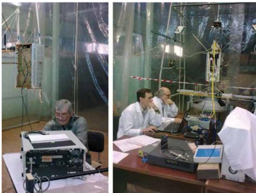
Рис. 16. Настройка приёмно-передающих антенн служебной радиолинии ДОКА
