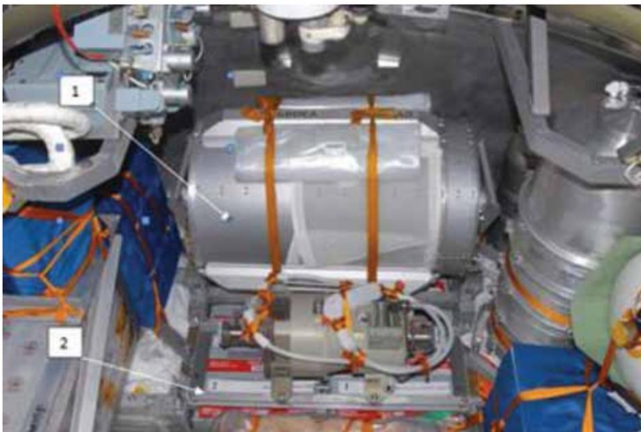
**Рис. 22.** Технический комплекс Байконур. ТПК с МС «Чибис-М», установленный на транспортировочной раме в грузовом отсеке ТГК «Прогресс М-13М»: 1 — ТПК с МС «Чибис-М»; 2 — транспортировочная рама
