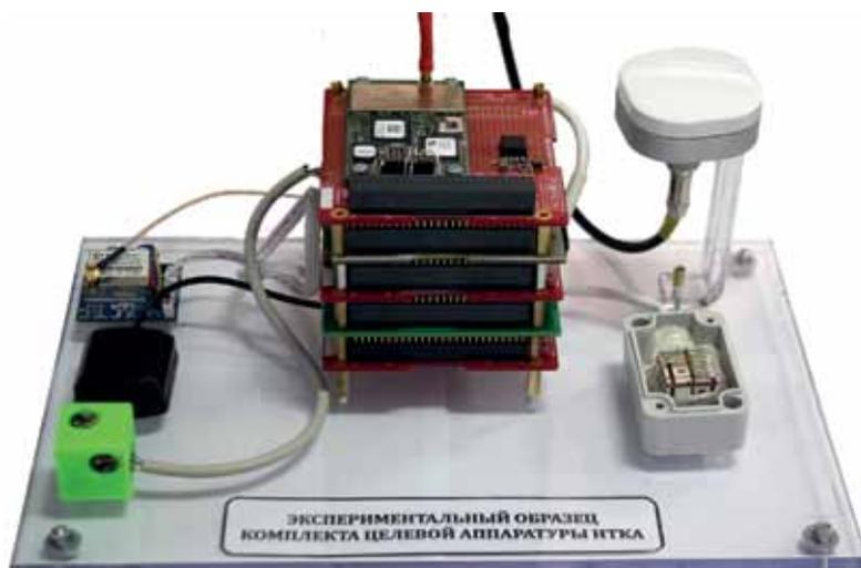
Экспериментальный образец целевого бортового оборудования НТКА в сборе
