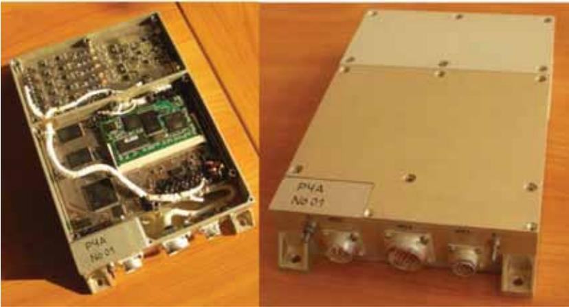
Рис. 6. Радиочастотный анализатор
