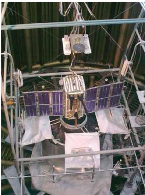
**Рис. 20.** ОАО «РКК «Энергия», г. Королёв. Момент выхода МС «Чибис-М» из ТПК и раскрытие солнечных батарей в ходе проведения термовакуумных испытаний
