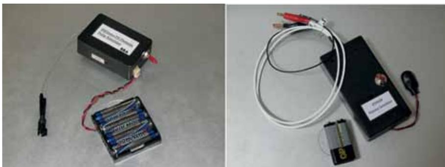
Рис. 13. Симуляторы PMTomo Photonic Pulse Simulator и ETPEDP Plasma Simulator
