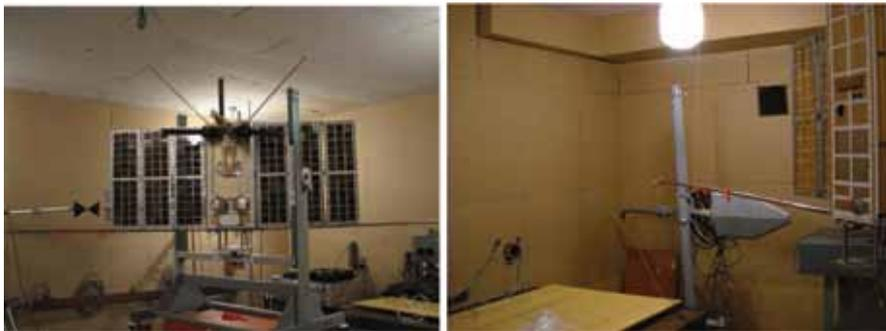
**Рис. 18.** ИКИ РАН, Москва. Испытания «Чибис-М» в экранированной камере: слева — по параметрам электромагнитной совместимости; справа — на устойчивость к внешним излучениям
