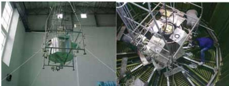
**Рис. 19.** ОАО «РКК «Энергия», г. Королёв. Слева — загрузка стэнда обезвешивания в термовакуумную камеру; справа — размещение ТПК с образцом КДИ «Чибис-М» в термовакуумной камере. Вид сверху
