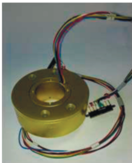
Рис. 8. Беспроводное энергетическое устройство со скользящими контактными кольцами (wireless power slip rings)
