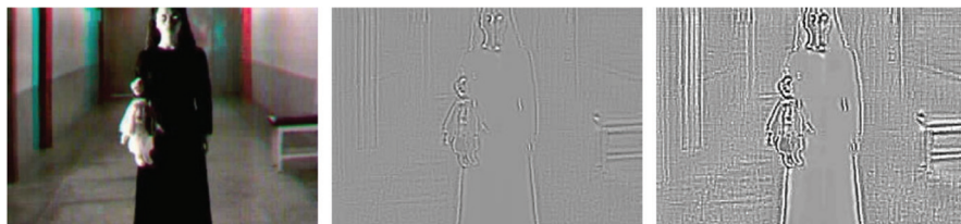
Рис. 3. Применение ортогональной фильтрации к изображению: слева — исходная фотография; по центру — «быстрая компонента»; справа — результат контрастирования быстрой компоненты (авторская методика)
