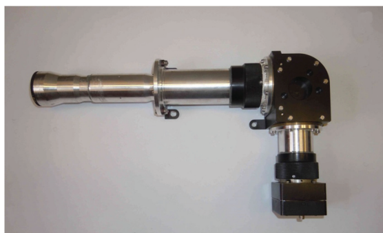
Рис. 4. Гиперспектральный модуль ВИД-ИКЗ
