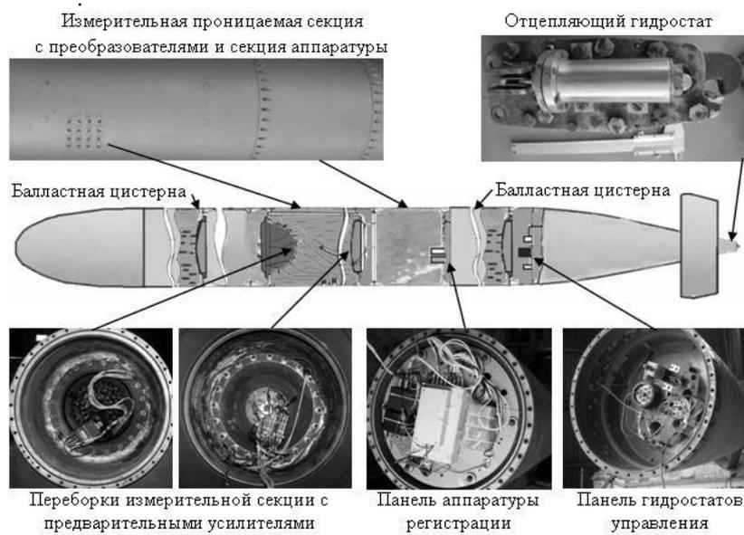
**Рис. 3.** Структура Всплывающего устройства.
