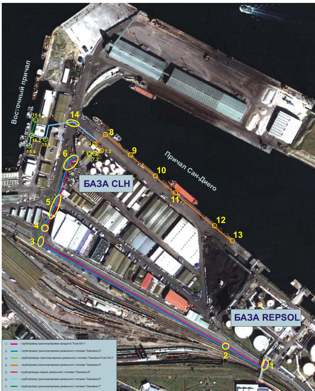
Рис. 12. Области, которые могут оказать отрицательное влияние на нормальную работу трубопроводов на территории порта Ла Коруна
