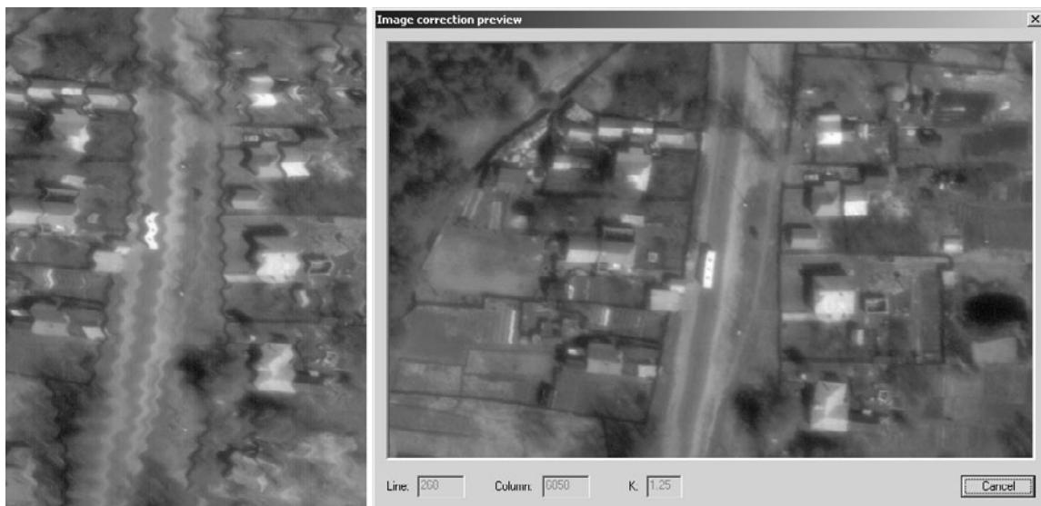
Рис. 7. Фрагмент реального изображения, полученного при летных испытаниях камеры ЦТК-140 и скорректированного программой “DeChatter” в автоматическом режиме.
