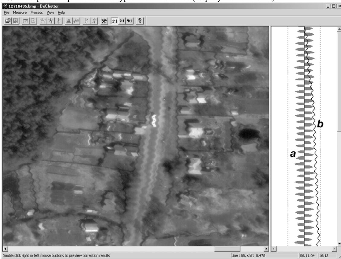
Рис.3. Главное окно программы “*DeChatter*”. Слева отображается фрагмент подлежащего коррекции изображения. Приведенное изображение получено при летных испытаниях цифровой аэрокамеры ЦТК-140 (съемка с высоты 6000 м, 06.05.2004). Справа отображаются график оценки сдвиги строки относительно предыдущей (*a*) и график накопленной величины сдвига строки (*b*).
