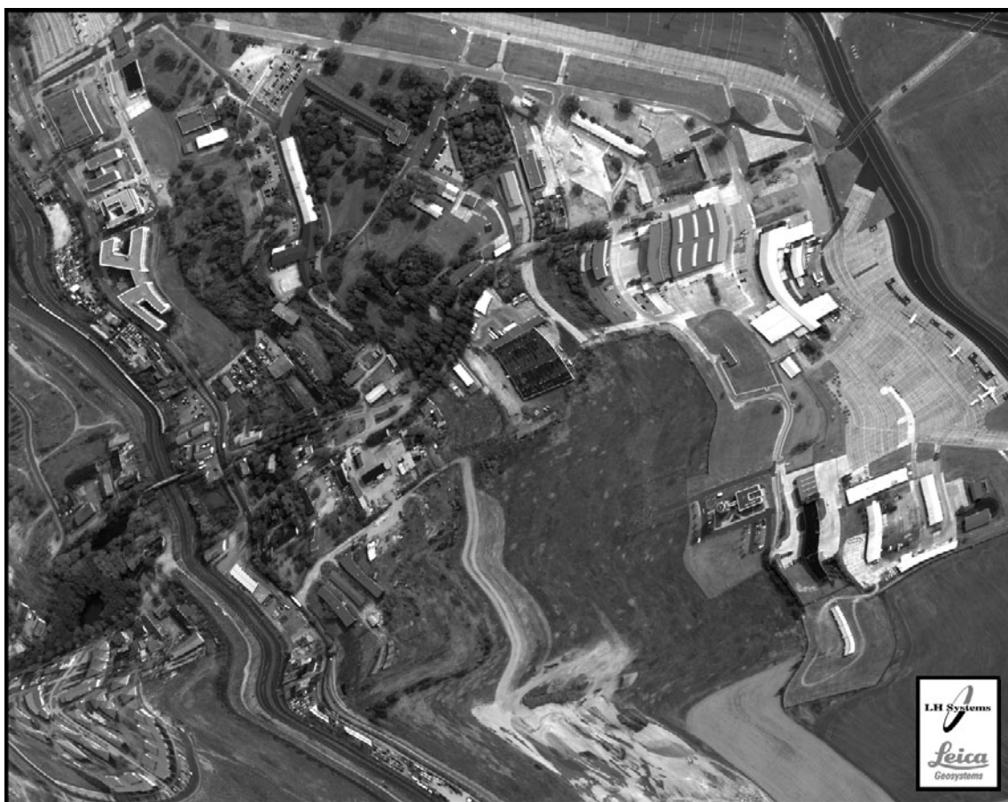
Рис.1. Изображение окрестностей Берлина, полученное цифровой аэрокамерой ADS40 (LH Systems). Геометрические искажения изображения вызваны изменением угловых и линейных ЭВО в процессе съемки.
