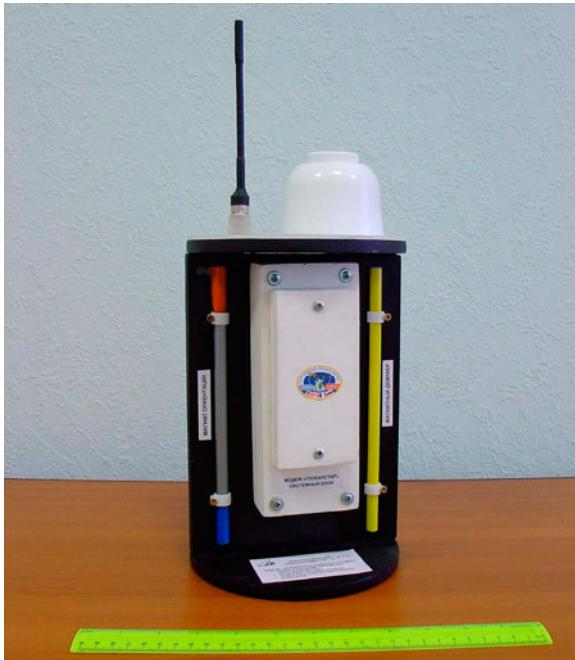
Рис. 13. Технологический наноспутник минимальной комплектации **ТНС- 0**
