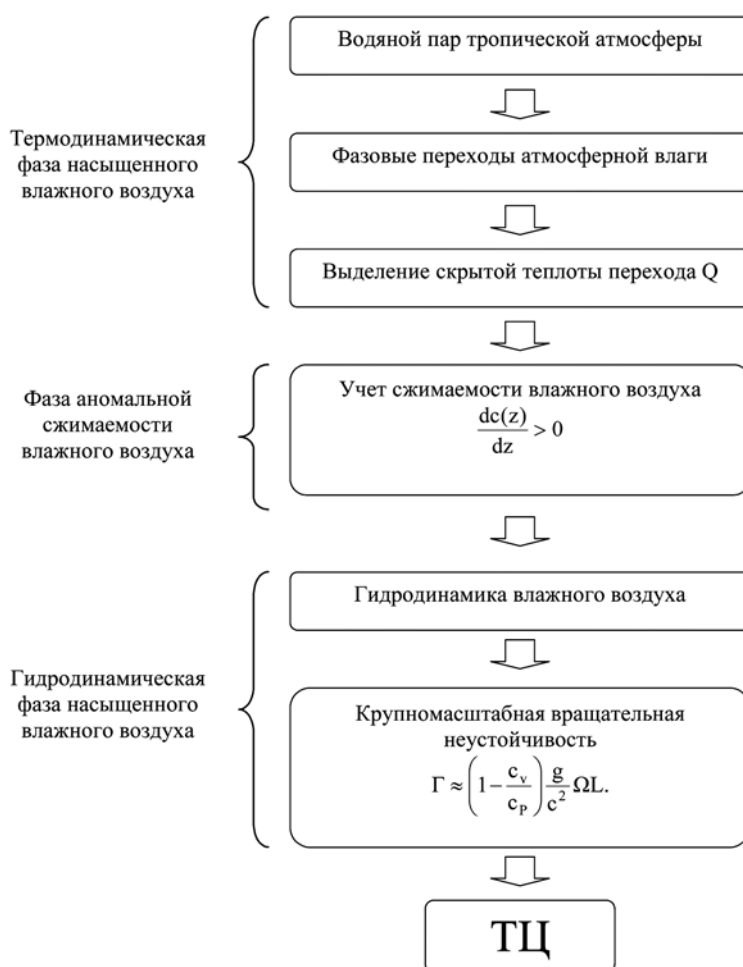
Рис. 1. Основные фазы (элементы) модели вращательной неустойчивости, обусловленные аномальным вертикальным распределением скорости звука в насыщенной водяным паром атмосфере
