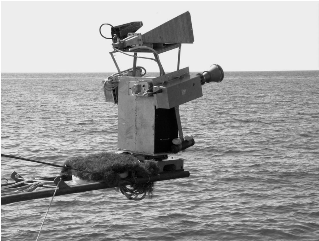
Рис. 3. Сканирующий комплекс микроволновых радиометров
