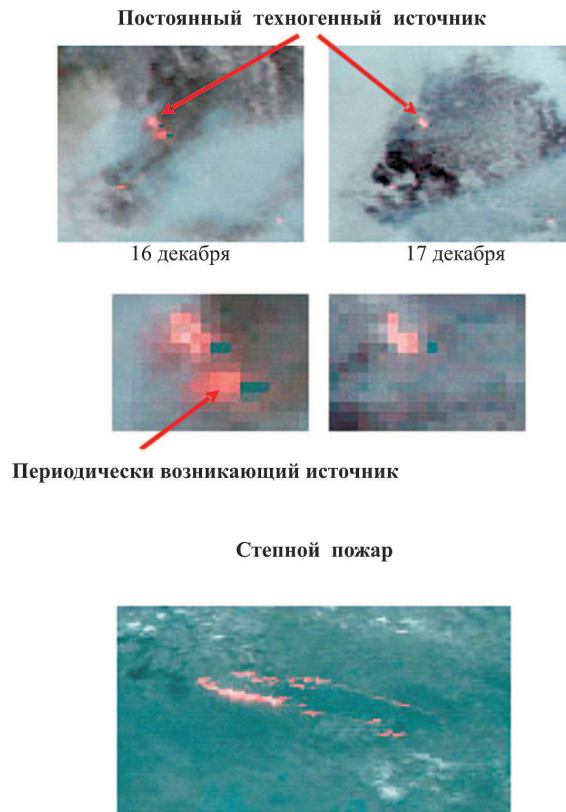
Рис. 1. Примеры ночных снимков NOAA/AVHRR тепловых источников в районе Прикаспийской нефтедобычи 16,17 декабря 2002 год. Псевдоцветной композит RGB 344
