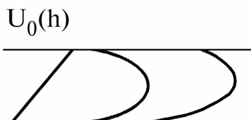
Рис. 1. Проблема Куэтта–Пуазейля. Вид области течения и профили скорости течений Куэтта, Пуазейля и Куэтта–Пуазейля (слева направо)
