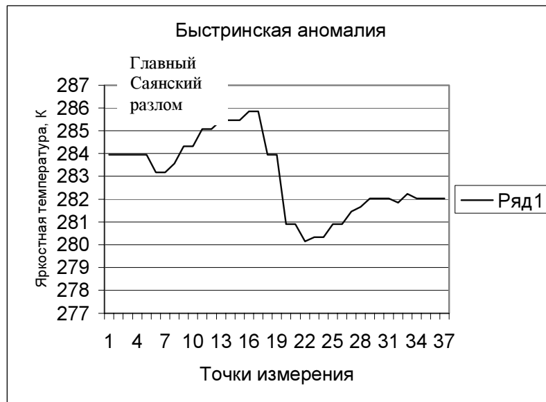
Рис. 3. Диффузная структура аномального ИК-излучения на Главном Саянском разломе (Быстринская аномалия, восточное Прибайкалье)
