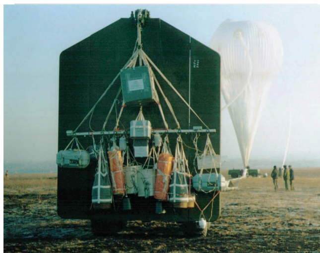
Рис. 2. Стандартная подвеска аэростата с магнитным градиентометром на борту в стартовой позиции (г. Вольск, 2005 г.)
