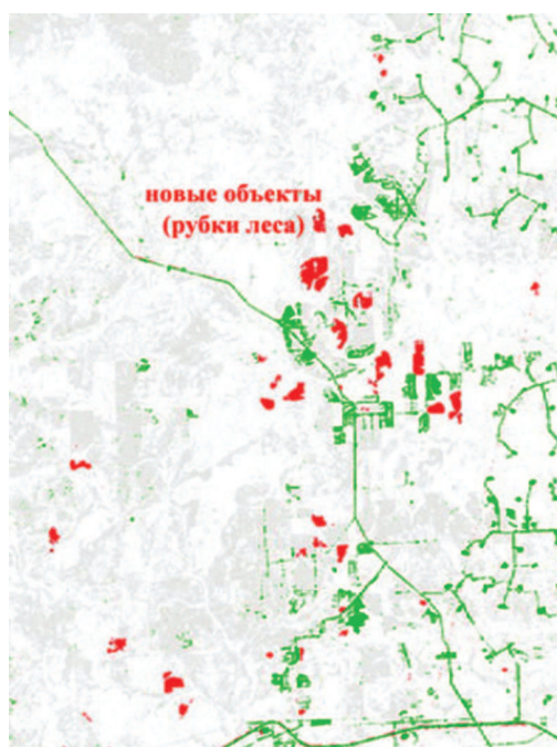
Рис. 6. Результат обработки двух разновременных снимков LandSat-7 (01/07/2002г) и Метеор-3М (27/06/2004 г)
