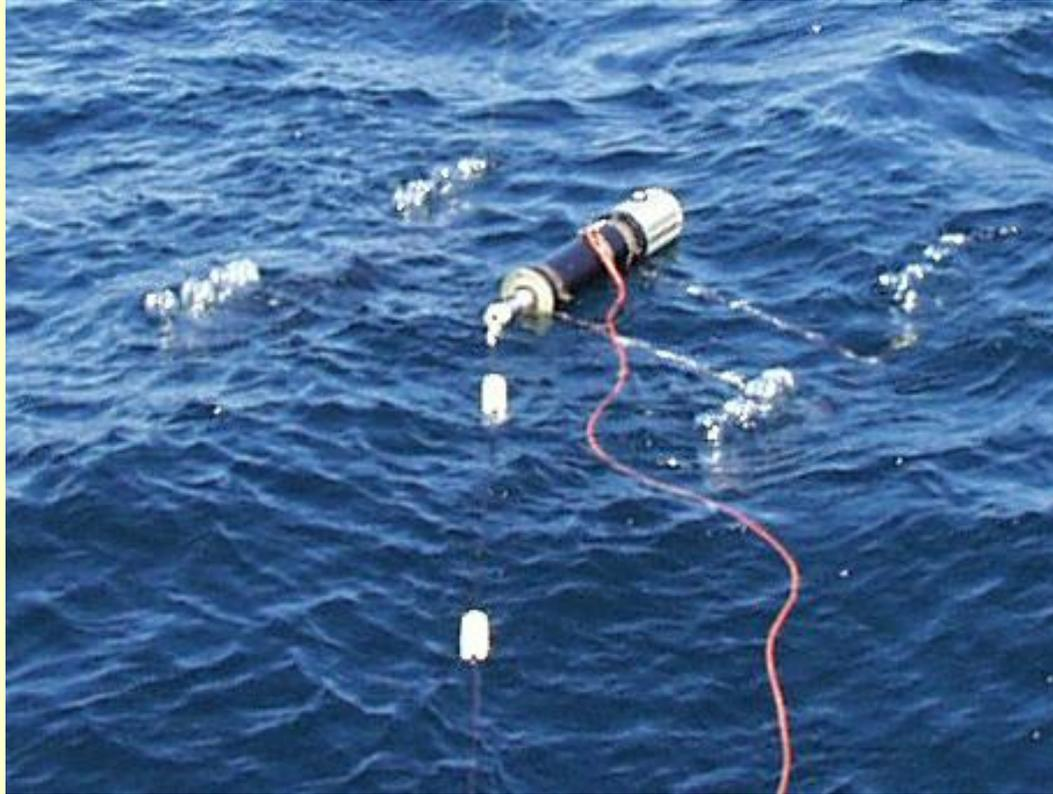
Измеряет абсолютные величины спектральной облученности над поверхностью моря и яркости излучения, выходящего из водной толщи, непосредственно под поверхностью. Измерения проводятся на расстоянии порядка 50 м от судна, чтобы избежать влияния корпуса судна на измерения. Спектральный диапазон - 390-700 нм; спектральное разрешение - 2.5 нм; точность измерений - 5%.
