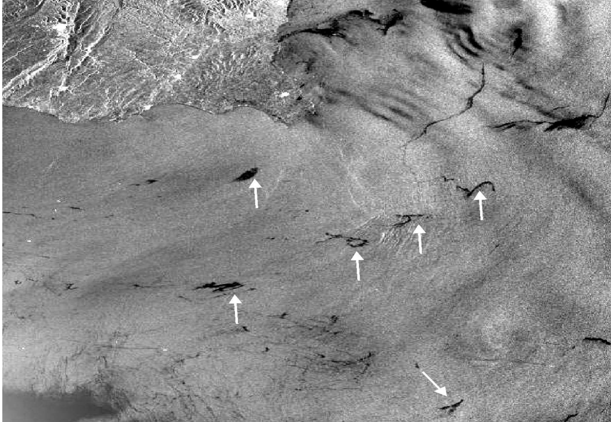
Рис.7. Шлейфы пленок УВ над природными просачиваниями нефти на дне Средиземного моря у Сицилии (показаны стрелками). По данным спутника ERS-1.
