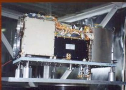
**OMEGA:** картирующий спектрометр
