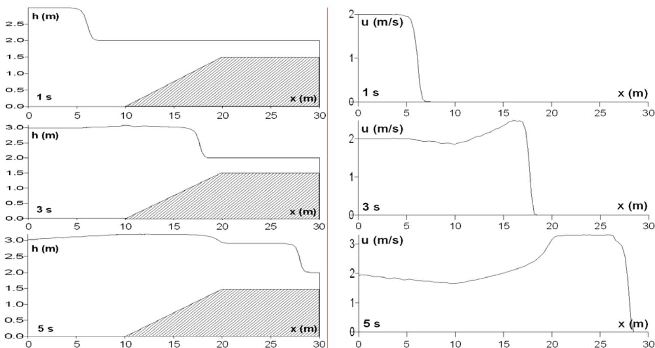
**Рис.2.** Эволюция глубины (слева) и скорости (справа) натекающей на наклонный берег, аппроксимируемый ступеньками, ударной волны.
