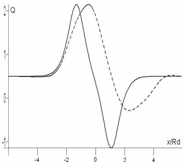
**Рис.4.** Потенциальная завихренность в начальный (сплошная линия,  $t=0T_f$ ) и конечный (пунктирная линия,  $t=16T_f$ ) моменты времени.
