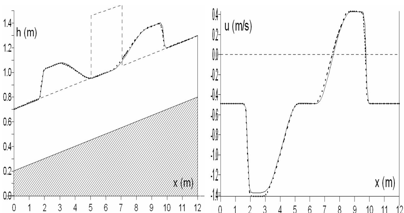
**Рис.1.** Глубина (слева) и скорость (справа) потока жидкости над затопленной наклонной поверхностью в момент  $t = 1$  с. Пунктирная линия – начальные параметры потока. Сплошная линия – параметры потока, полученные с помощью квазидвухслойного метода. Поточечная линия – параметры потока, полученные с помощью расчета, использующего стандартный метод Годунова с последующей заменой переменных.
