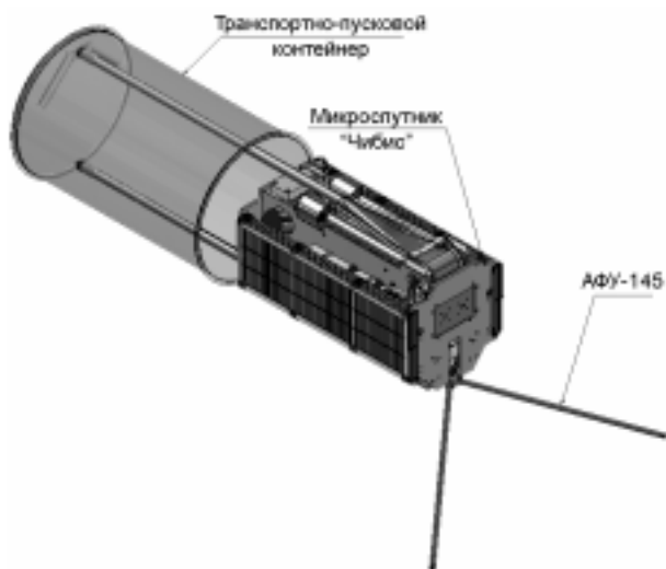
Рис. 2. Расчетовка и развертывание двух гравитационных устройств (ленточных штанг) системы ориентации спутника СОС ГУ приводит к выталкиванию микроспутника «Чибис» из транспортно-пускового контейнера
