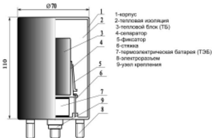
Рис. 3. Конструктивная схема РИТЭГ «Арес»
