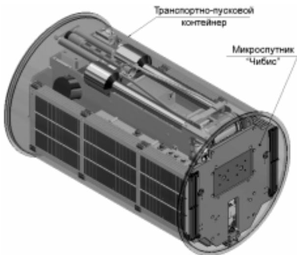
Рис. 1. Микроспутник «Чибис» в сложенном состоянии упакован в транспортно-пусковом контейнере (схема)
