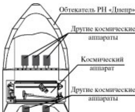
Рис. 6. Размещение космического аппарата под обтекателем РН «Днепр»
