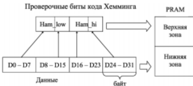
Рис. 2. Расположение данных и проверочных бит кода Хемминга в PRAM
