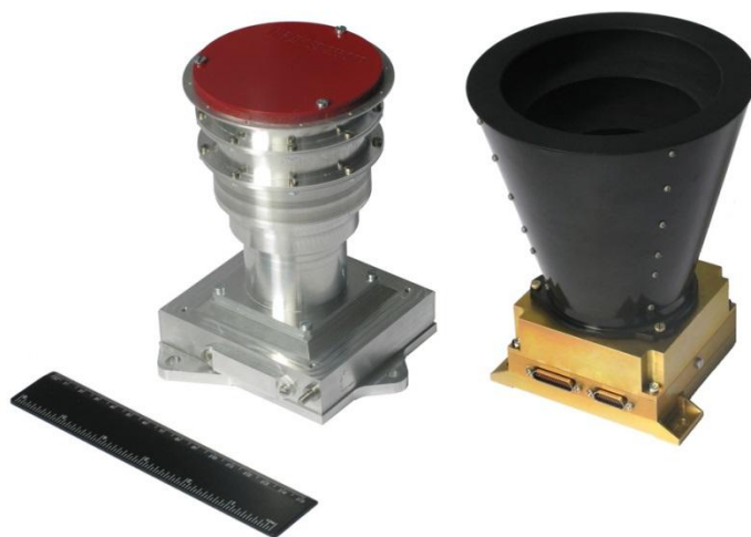
Рисунок 1 Макеты оптических головок с фокусным расстоянием объектива 24 мм (слева) и с фокусным расстоянием объектива 36 мм (справа)
