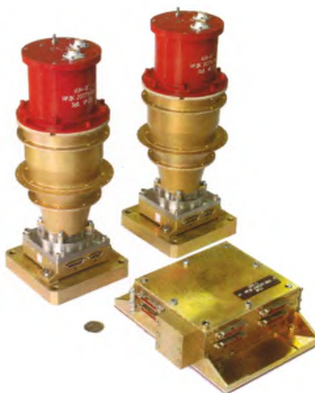
Рисунок 3 - Внешний вид прибора звездной ориентации мБОКЗ-2, состоящий из двух оптических головок и блока обработки данных
