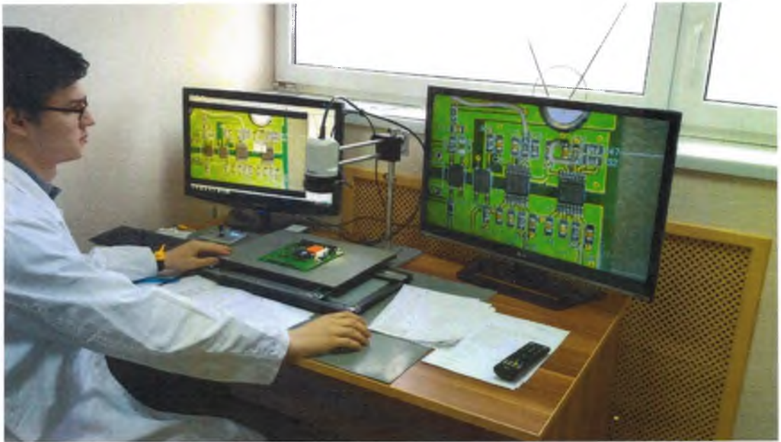
Рисунок 14. Оснащение рабочего места контроля печатных плат бортовой научной аппаратуры
