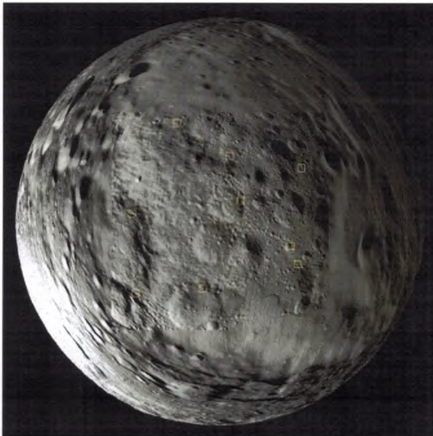
Рисунок 1.2 – Модельное изображение, получаемое камерой с полем зрения 180° с высоты 10 км на этапе подлета к месту посадки «Луна-Глоб»; центральная часть изображения, по которой проводится выбор контрольных точек, моделировалась по искусственной топографической модели разрешением 12 м, остальная часть – по модели LOLA256P с разрешением 120 м; детектированные контрольные точки показаны желтым цветом; ошибки оценки положения КА: по долготе – 1,4 м, по широте – 1,6 м, по высоте – 4,4 м
