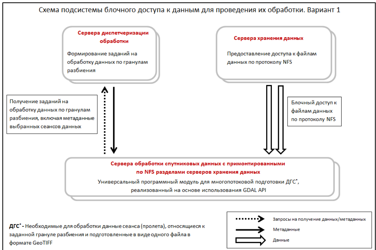
Рисунок 3.1.3.1. Схема организации блочного доступа к данным с использованием прямого доступа к данным архивов со стороны серверов обработки.
