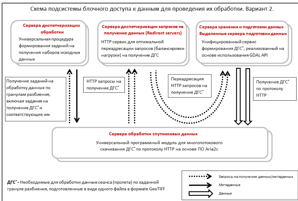
Рисунок 3.1.4.1. - Схема организации блочного доступа к данным с использованием серверов предварительной подготовки необходимых наборов спутниковых данных.
