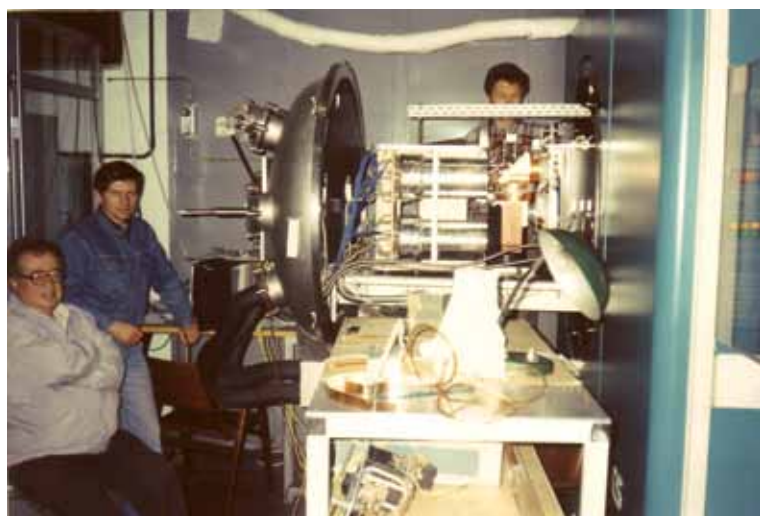
Рис. 2. Вверху: открытая вакуумная камера ИФСИ, приготовленная для калибровки ДВК ПФС: 1 — зев вакуумного объёма; 2 — крышка вакуумного объёма; 3 — рельс, с помощью которого перемещалась крышка 2; 4 — платформа камеры ПФС-О; 6 — радиатор ПФС-О; 7 — охлаждаемая жидким азотом плита, параллельная радиатору 6, но не касающаяся его; 8 — магистрали жидкого азота (проходят через фланец в крышке 2); 9 — абсолютно чёрное тело (АЧТ) «планета»; 10 — АЧТ «космос»; 11 — сканер (ПФС-С); 12 — лётное АЧТ (ПФС-А); 13 — имитатор кронштейна КА. Внизу: слева — В. И. и автор этих строк у вакуумной камеры во время калибровок
