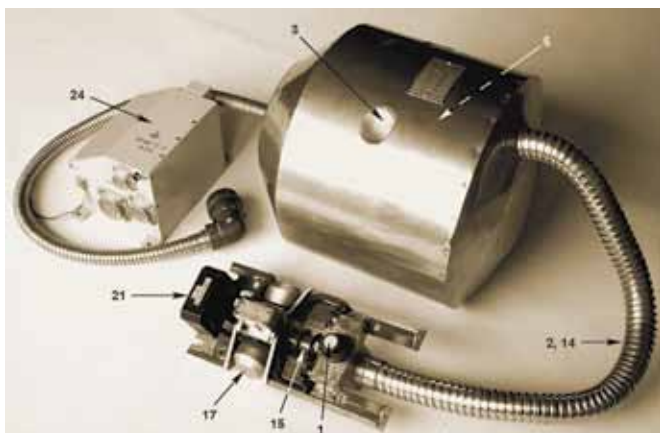
Рис. 5. Внешний вид прибора ИОАВ. Обозначения такие же, как на рис. 4, кроме поз. 24 — блок электроники. Световоды 2 и 14 помещены в металлорукав. Герметикапсула 5 не видна, так как находится внутри (под слоем теплоизоляции 3), и условно показана пунктирной стрелкой. Снаружи теплоизоляция 3 покрыта стальной фольгой
