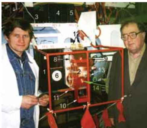
Рис. 3. Лётный образец прибора ПФС/МАРС-96 на имитаторе КА в контрольно-испытательной станции (КИС) ИКИ: справа — инициатор и научный руководитель эксперимента проф. В. И. Мороз; слева — технический руководитель (автор этих строк); 1 — оптический блок (ПФС-О), он «подвешен» к белому кронштейну КА через виброизоляторы; 2 — система наведения (ПФС-С, «сканер»); 3 — блок электроники сканера (ПФС-К); 4 — главный блок электроники (ПФС-Е); 5 — блок питания (ПФС-Р); 6 — ламбертовский экран (ПФС-Л, его выход сейчас открыт; вход же солнечного излучения, здесь это «сверху», закрыт защитной крышкой); 7 — наземное защитное ограждение; 8 — АЧТ для калибровки в полёте (ПФС-А, в составе сканера); 9 — фотометр видимого диапазона (ПФС-Т, «торометр», в составе сканера); 10 — наземный противовес вращения сканера вокруг оптической оси блока ПФС-О (она здесь горизонтальна, показана стрелкой О); 11 — радиатор блока ПФС-О (здесь закрыт защитной крышкой); 12 — арретир вращения сканера; 13 — арретир аварийного отстрела плоского зеркала 14
