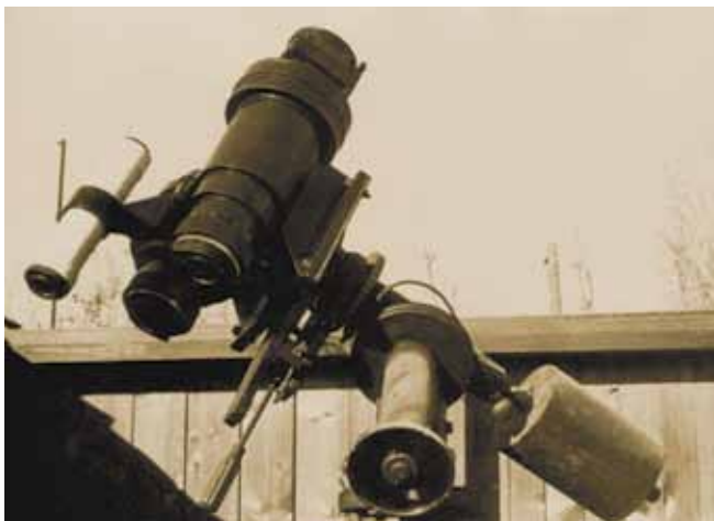
Созданная в ГАИШ камера для регистрации искусственных спутников Земли
