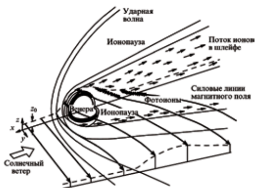
Рис. 6б. Основные процессы взаимодействия солнечного ветра с ионосферой планеты
