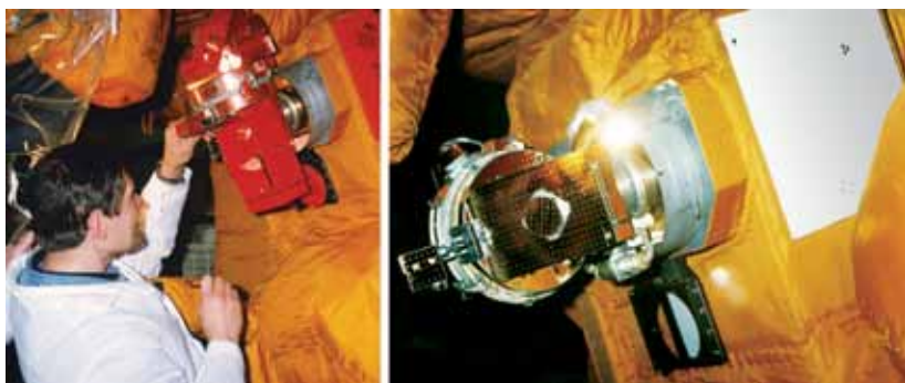
Рис. 4. Слева: автор этих строк производит в монтажно-испытательном корпусе (МИК) площадки № 31 космодрома Байконур заключительные операции с прибором ПФС; справа: перед накаткой головного обтекателя ракеты. Все защитные крышки сняты (за снятие каждой проставлена роспись в бортжурнале). Блок ПФС-О и окружающие конструкции были обшиты ЭВТИ золотистого цвета, снаружи оставались только сканер с ламбертовским экраном и радиатор (большой белый прямоугольник)
